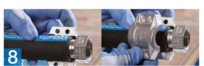
Danach Stutzen ggf. mit Seifenlauge bestreichen, in den Schlauch stecken und Halbschalen anlegen (Sitz der Schale am Sicherungsbund prüfen).
