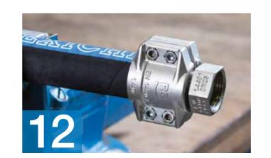
Vor Inbetriebnahme, frühestens jedoch 24 Stunden nach Erstmontage der Armaturen am Schlauch, sind die Schrauben nochmals festzuziehen. Fertig.
