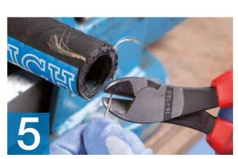
Die Stahlspirale mit Seitenschneider kürzen.
