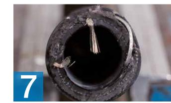
Kupferlitze so kürzen, dass sie mind. 10 mm, bzw. 1/3 der Stutzenlänge in den Schlauch hineinragen. Litzen längs zur Schlauchrichtung breit auffächern und nach innen biegen.
