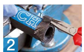
Eingeschnittenen Außengummi mit Zange entfernen.
