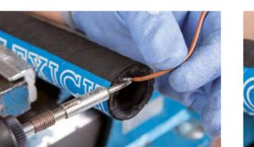
Dazu muss zuerst die Deckengummischicht an den Stellen der Kupferlitze mit einem Cutter freigelegt werden, danach wird der Draht angelötet.
