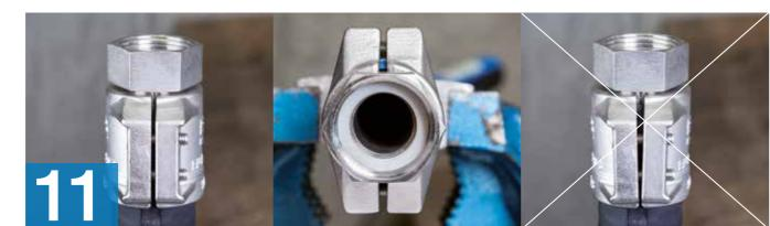
Nach der Endmontage muss bei richtig dimensionierten Schläuchen und Schalen der verbleibende Spalt zwischen beiden Schalen parallel und auf beiden Seiten gleich groß verlaufen.
