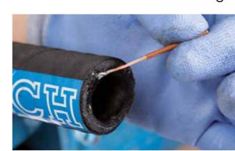
Die Isolierung des angelöteten Drahtes abziehen. Weiter mit Schritt 5.
