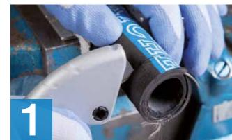
Außengummi rundherum mit Cutter einschneiden, dann Schnitt in Längsrichtung. Nicht zu tief schneiden, da sonst die Kupferlitze verletzt wird.
