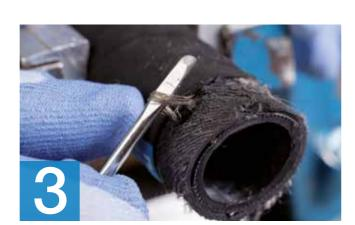
Beide Kupferlitzen mit Cutter und Zange freilegen und zurückbiegen.
