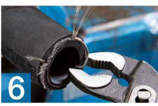
Mit einer Rohrzange die Stahlspirale nach innen biegen. Das Ende der Spirale fest in die Schlauchseele drücken, um den Schlauchstutzen bei Montage vor Verletzungen zu schützen. Der Abstand zur Schlauchseele darf ca. 3 mm betragen.
