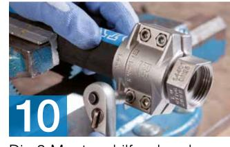
Die 2 Montagehilfsschrauben durch 4 mitgelieferte Standard-Schrauben ersetzen und über Kreuz anziehen.
